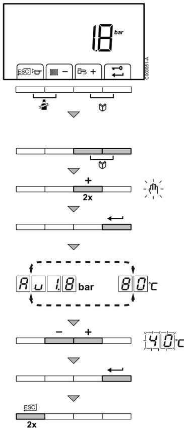
Dans certains cas, il est nécessaire de commuter la chaudière en mode manuel, par exemple lorsque le régulateur n'est pas encore raccordé. Sous le symbole
